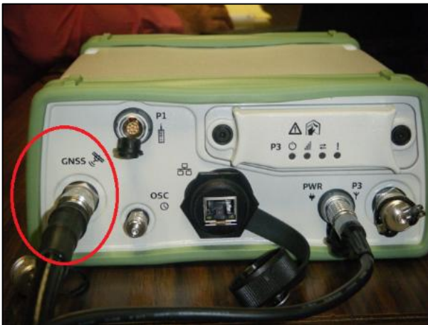
Ejemplo de conexión del cable coaxial de la antena al puerto GNSS del receptor.
