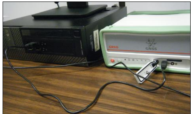
Conexión entre receptor y unidad de control mediante un cable USB (ejemplo)
