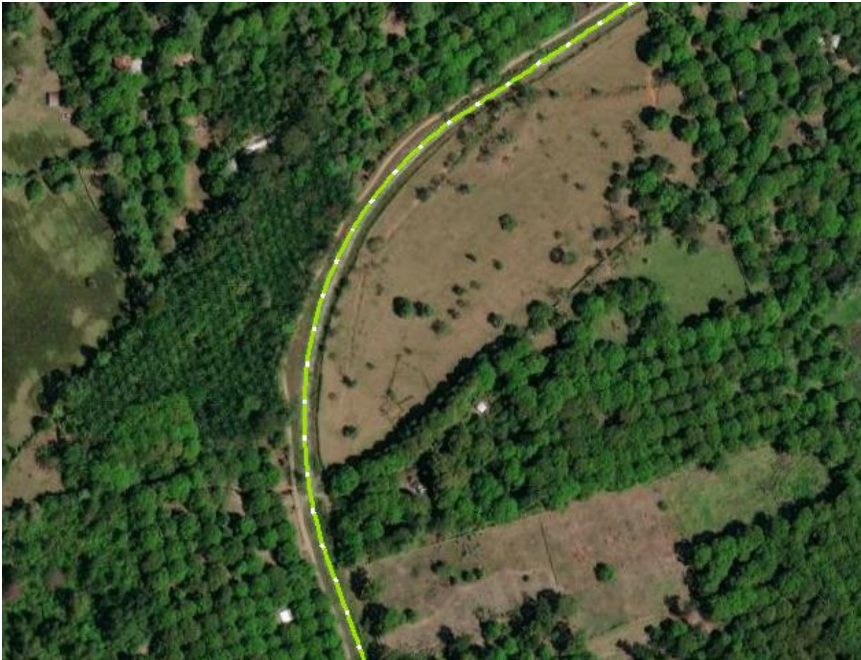
Fig. 3 Digitalización de vía ferroviaria
