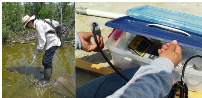
Figura 10.1. Toma de muestras de agua intersticial de suelo en los manglares y la medición de la salinidad y temperatura con la sonda multiparámetros.
