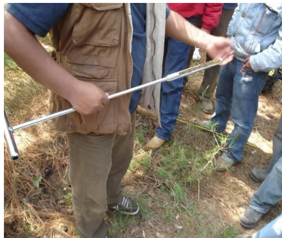
Figura 8.9. Extracción de la barrena y medición de la profundidad efectiva de muestreo..
